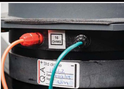
Zamiast zwór/złączek zastosowano 4-milimetrowe otwory na wtyki bananowe, którymi zakończono przewody głośnikowe biegnące od zwrotnicy.
