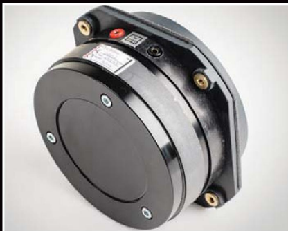
Zamiast zwór/złączek zastosowano 4-milimetrowe otwory na wtyki bananowe, którymi zakończono przewody głośnikowe biegnące od zwrotnicy.
