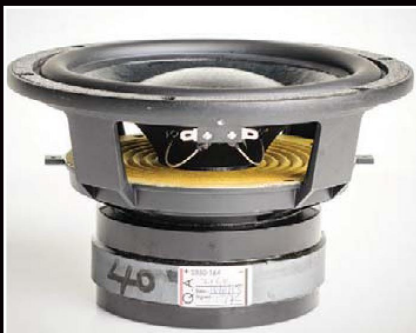
Niskotonowiec o nominalnej średnicy 164 mm waży 4,3 kilograma. Niezła proporcja!
